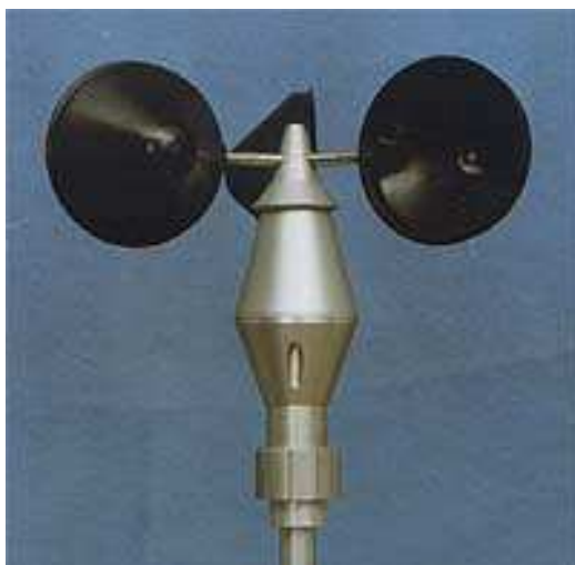
Figuur 1. KNMI cup-anemometer met drie cups (niet exact halve bollen).
