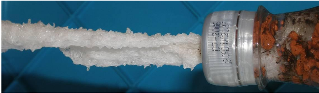
Figuur 4: Een reep handdoek is als watergeleidend materiaal is bevochtigd en door het gat in de flessendop gehaald, en zal water van het onderste naar het bovenste flessencompartiment leiden.
